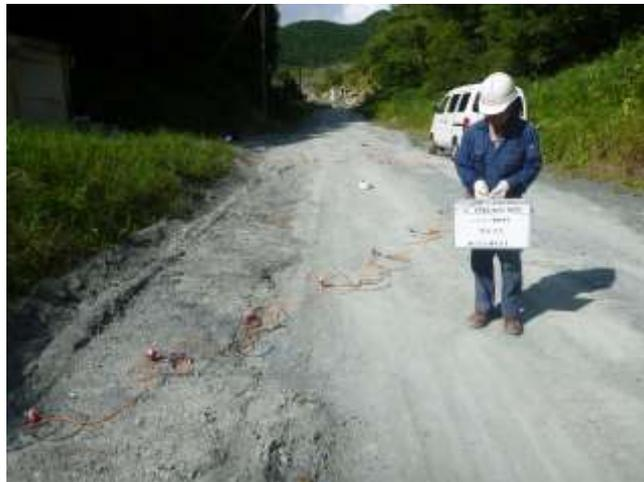
L字アレイ微動探査 1m間隔測線展開状況
