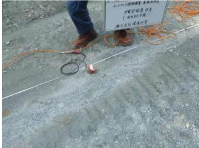
微動探査・表面波探査 地震計設置状況
