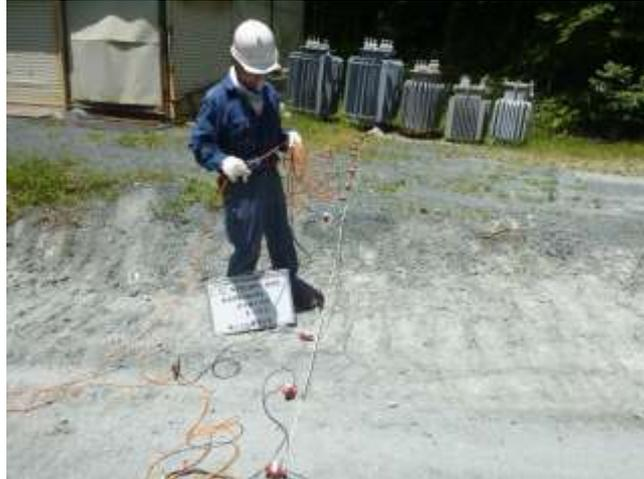
リニアアレイ微動探査・表面波探査 堤体軸上測線 0.5m間隔測線展開状況
