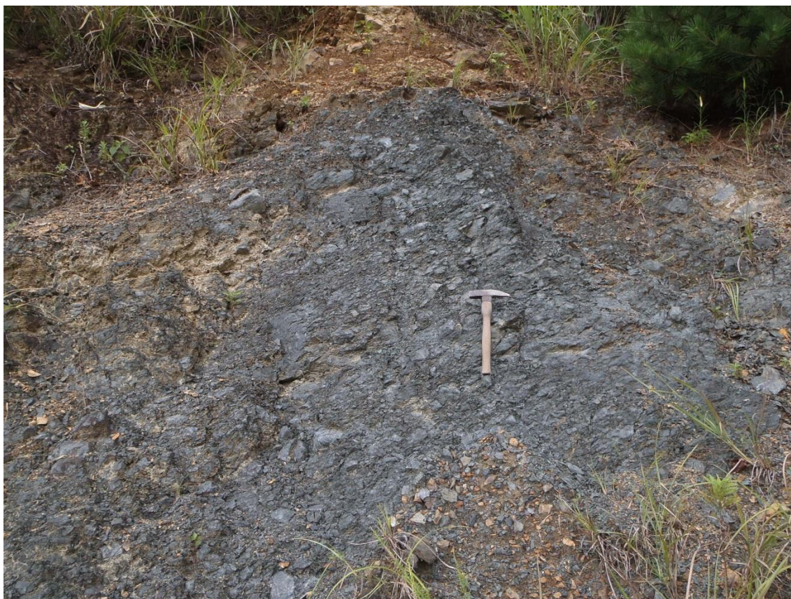
E87 CL~D 級の片状緑色岩(一部蛇紋岩化):N48E39N 方向割れ目卓越
