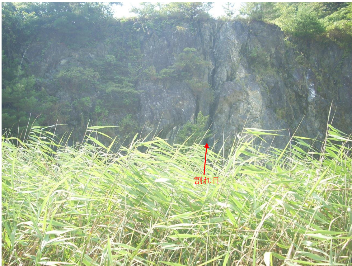
E37 N71W72S 方向の割れ目と CH~CM 級の緑色岩
