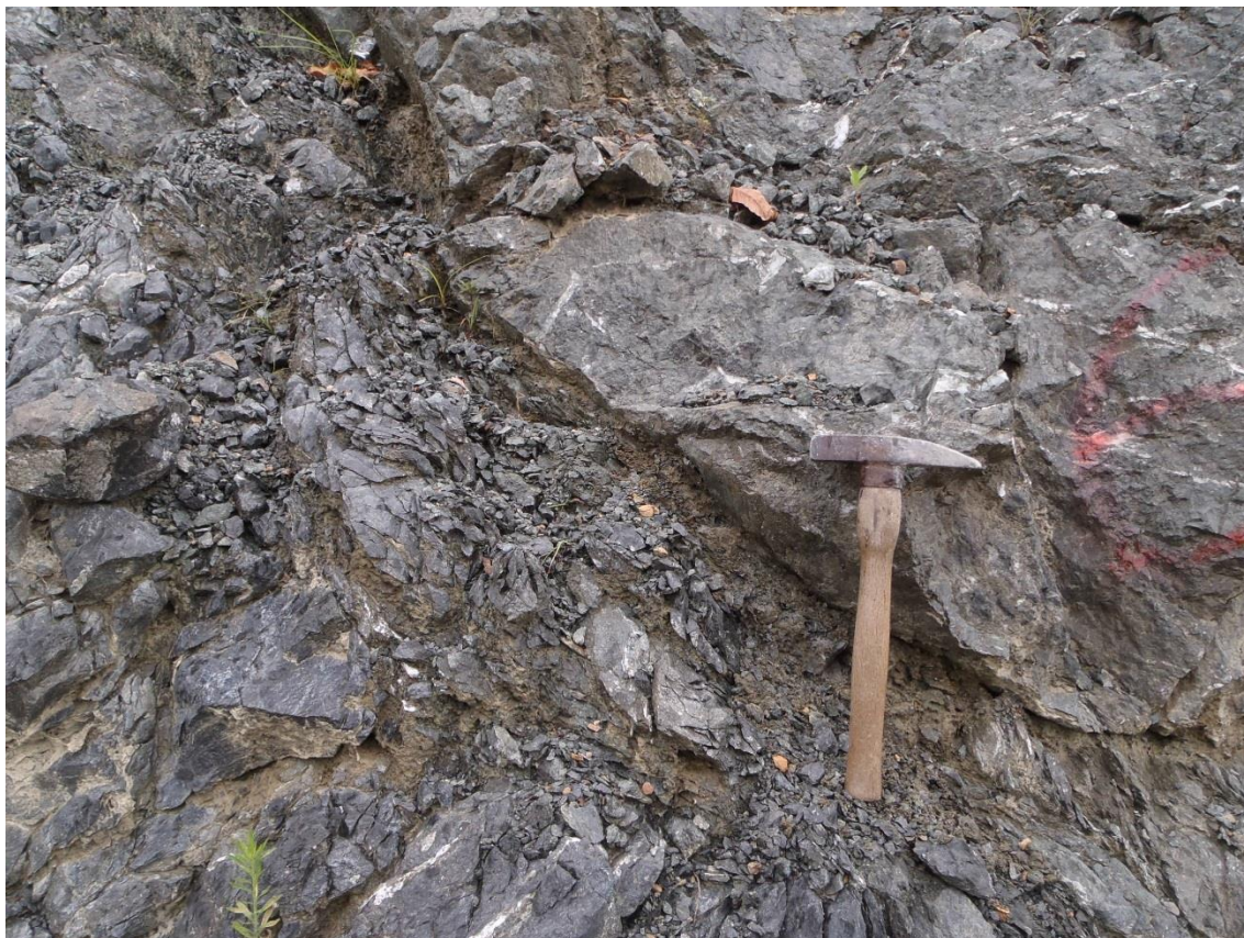
E91 N88E60S 方向の断層(破碎部)
