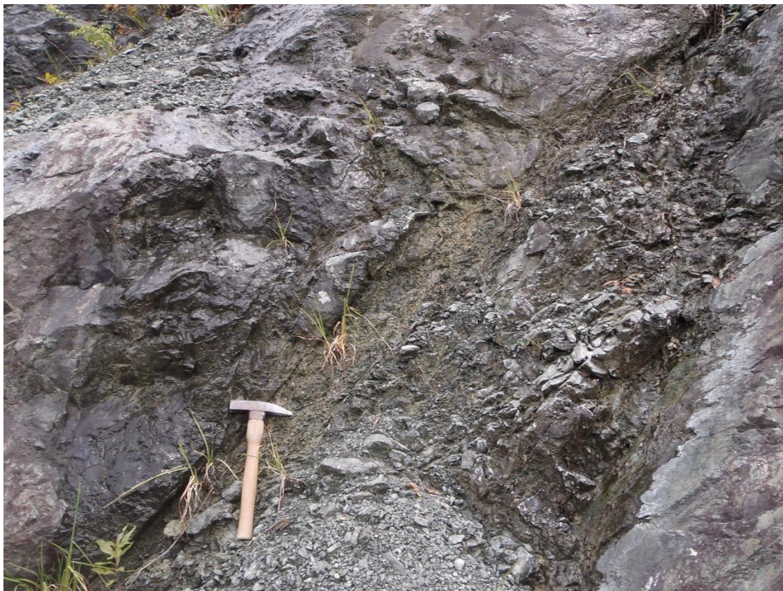
E57 N88E52N 方向の断層(破碎部)
