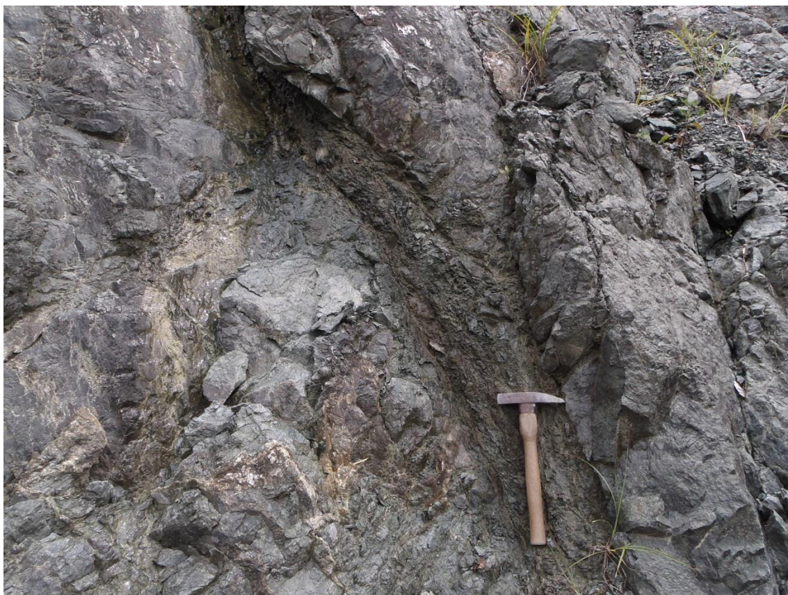
E59 N27W64W 方向の断層(破碎部)
