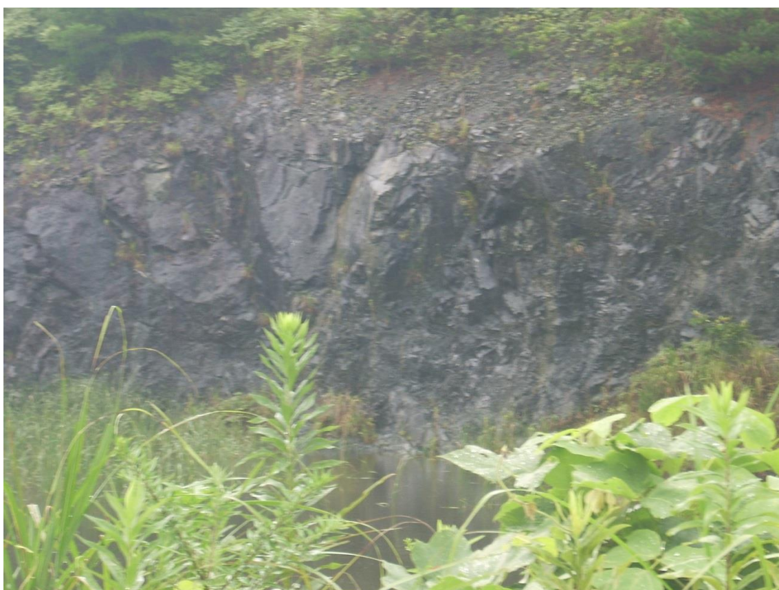
W12 N37E80E 方向の割れ目を境に左 CH 級・右 CM 級の緑色岩
