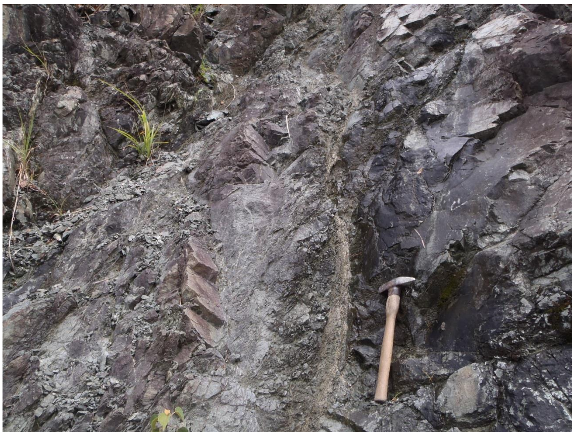
E55 N17E53W 方向の断層(破碎部)
