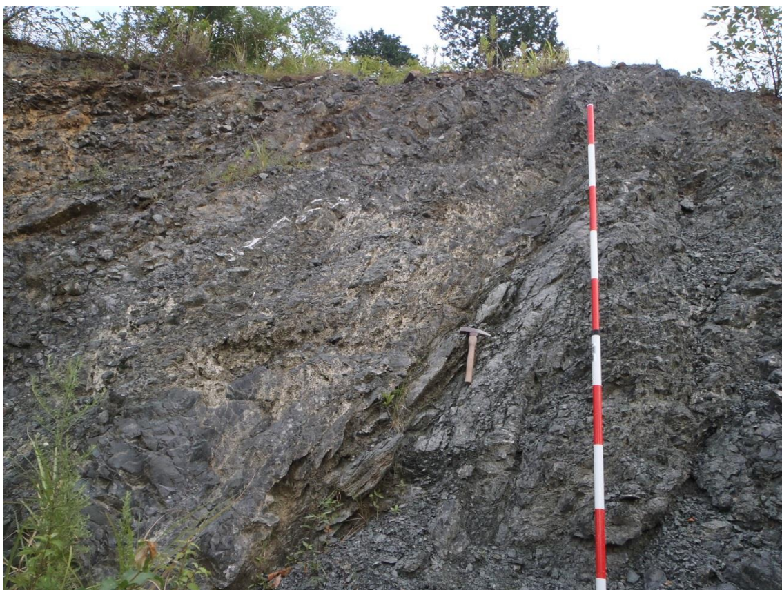
E97 N73W51N 方向の割れ目の卓越した CL 級の緑色岩
