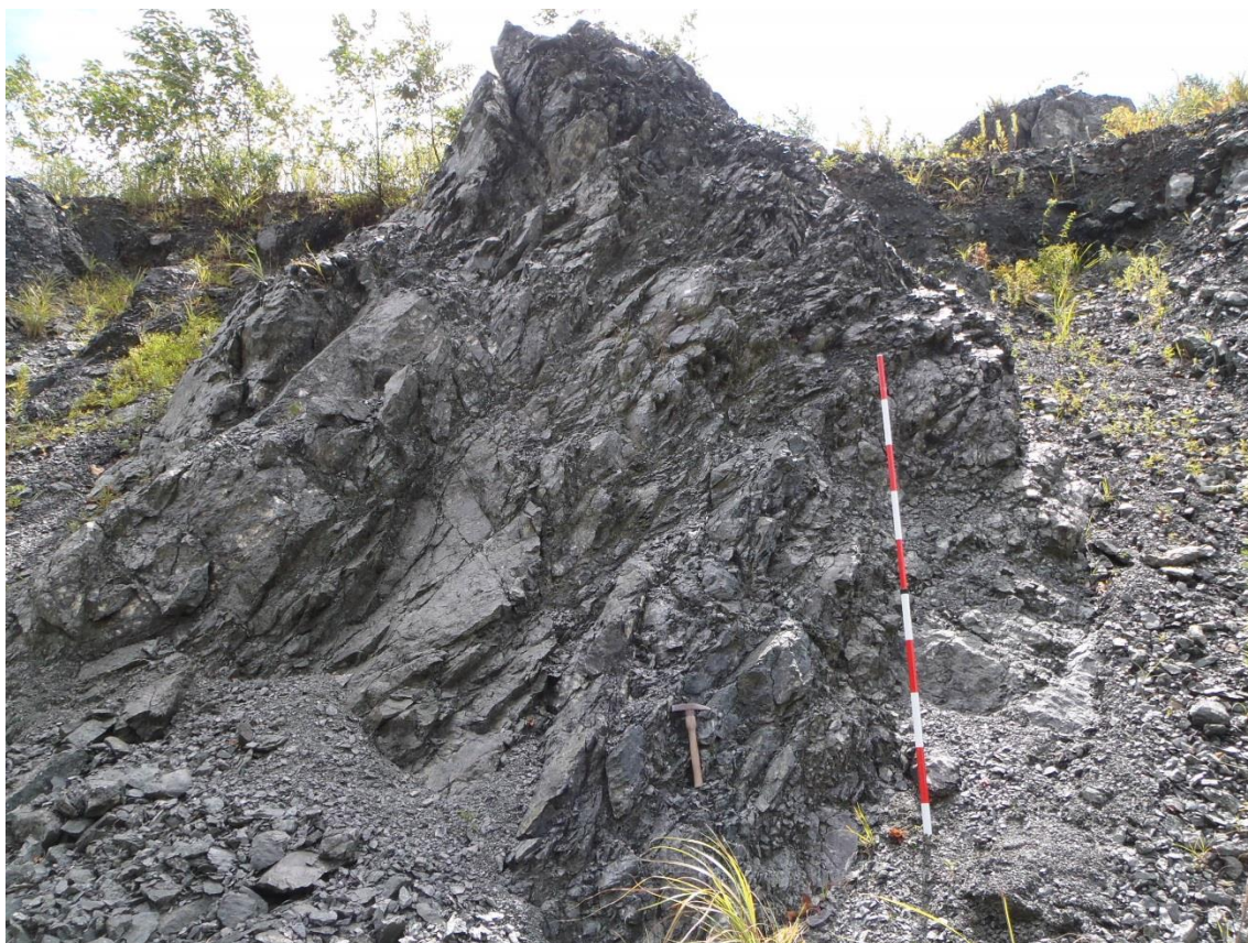
E41 CM～CL 級の片状緑色岩(一部蛇紋岩化)と N85E48N 方向の割れ目
