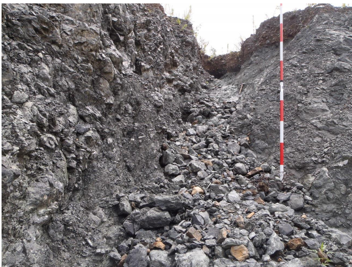
E62 N30W42E 方向の断層(全景)：下部はズリに覆われている
