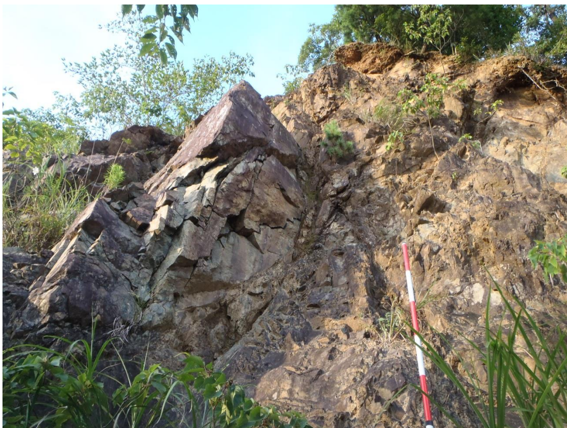
E92 N69E80S 方向の割れ目の卓越した CM~CH 級の緑色岩
