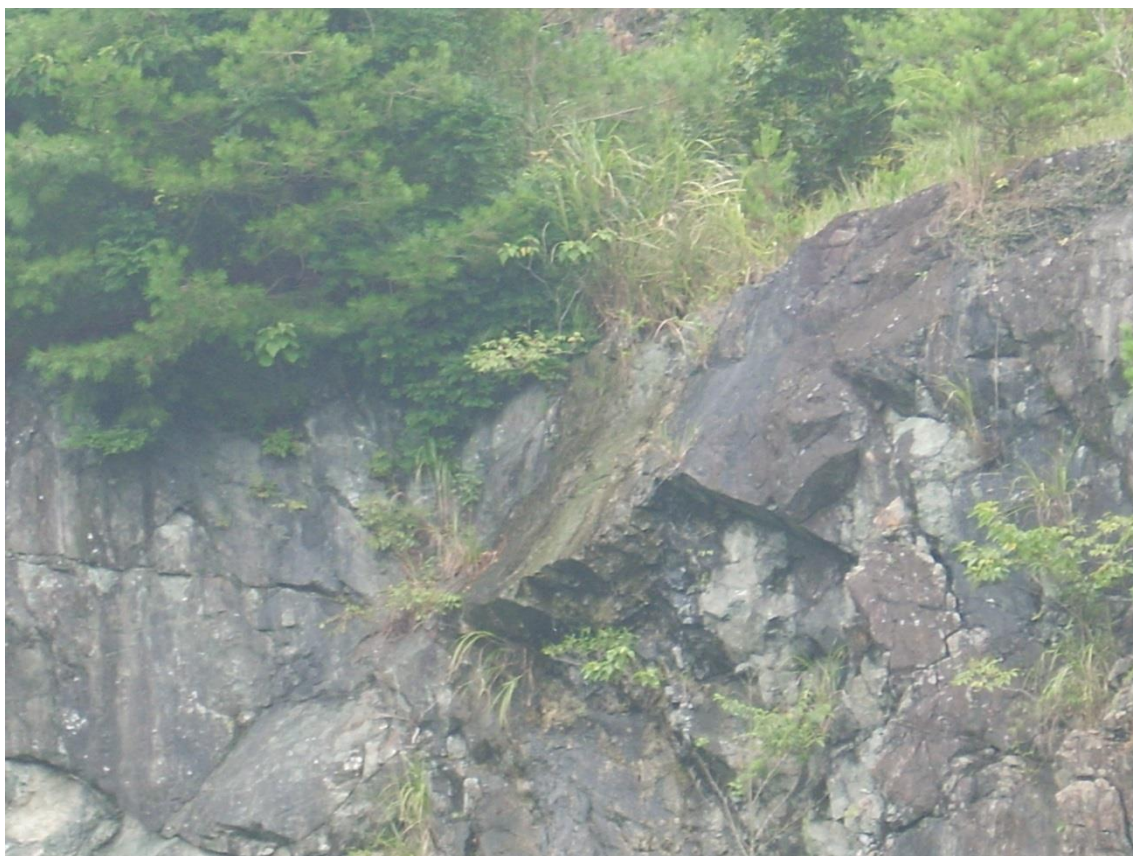
W11 N72W55S 方向の割れ目の卓越した CH 級の緑色岩
