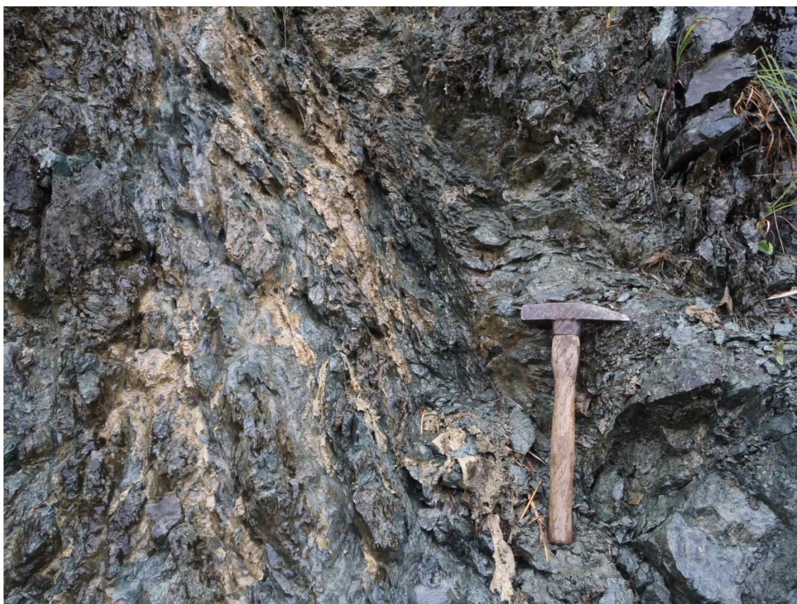
E16 N86W67S 方向の断層(破碎部)
