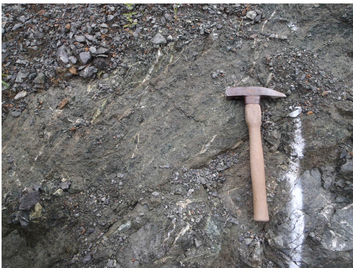
E84 N39E50E 方向の断層(破碎部)
