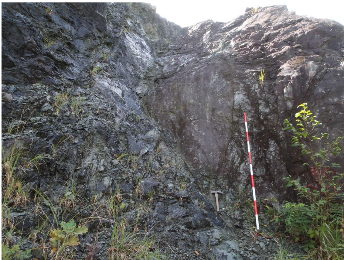
E39 N48W56N 方向の断層(全景)
