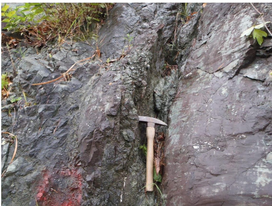
E12 N58E68N 方向の断層(破碎部)
