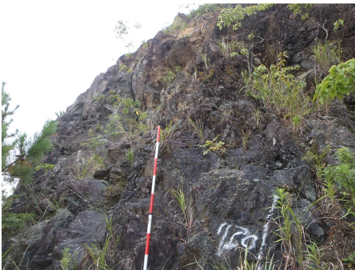
E98 CH~CM 級の緑色岩:3~4 方向の割れ目が見られる
