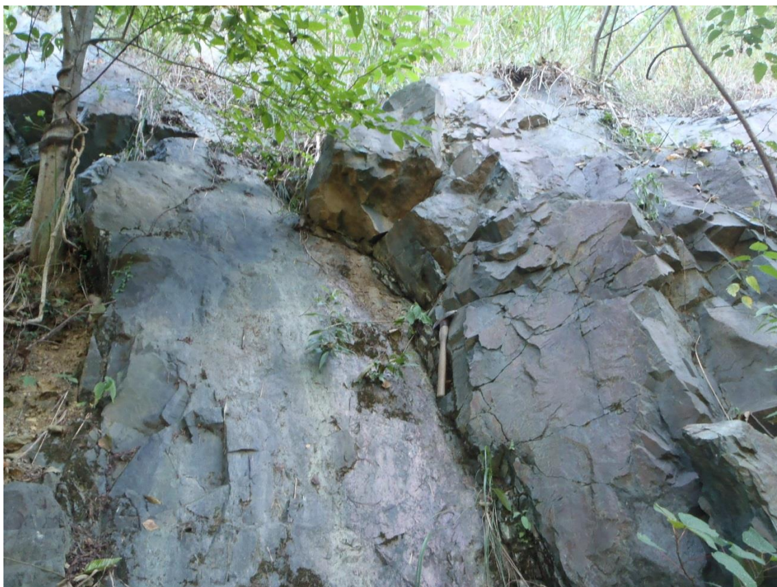
W3 N40W56E 方向の割れ目の卓越した CH~CM 級の緑色岩
