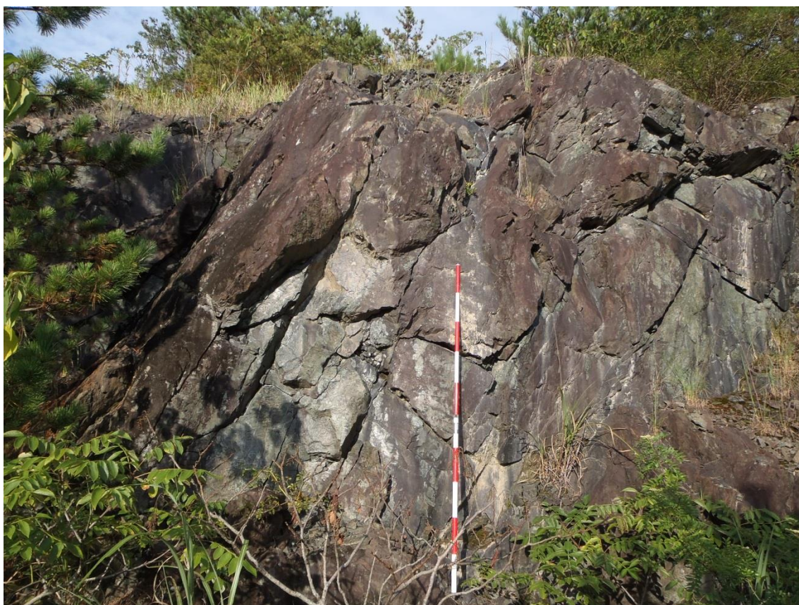
E70 N54E60N 方向の割れ目が卓越した CH~CM 級の緑色岩
