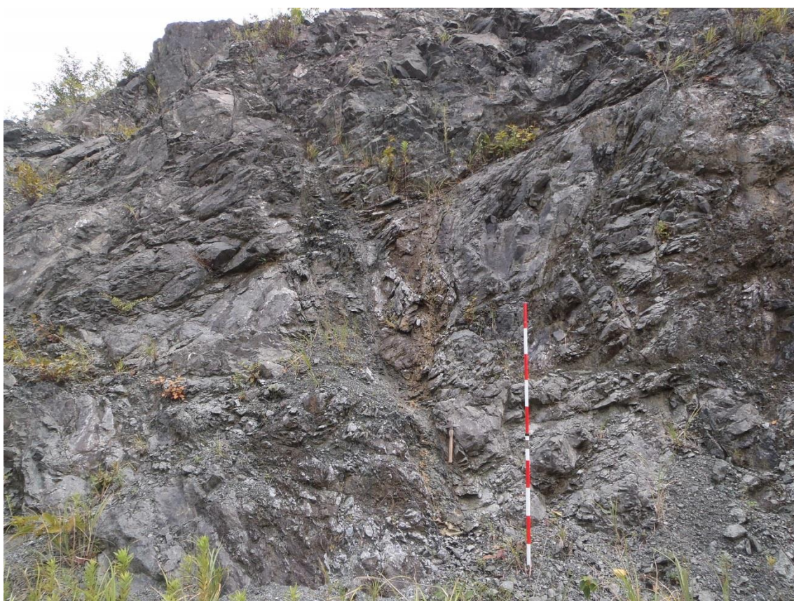
E60 N78W64S 方向の断層(全景)
