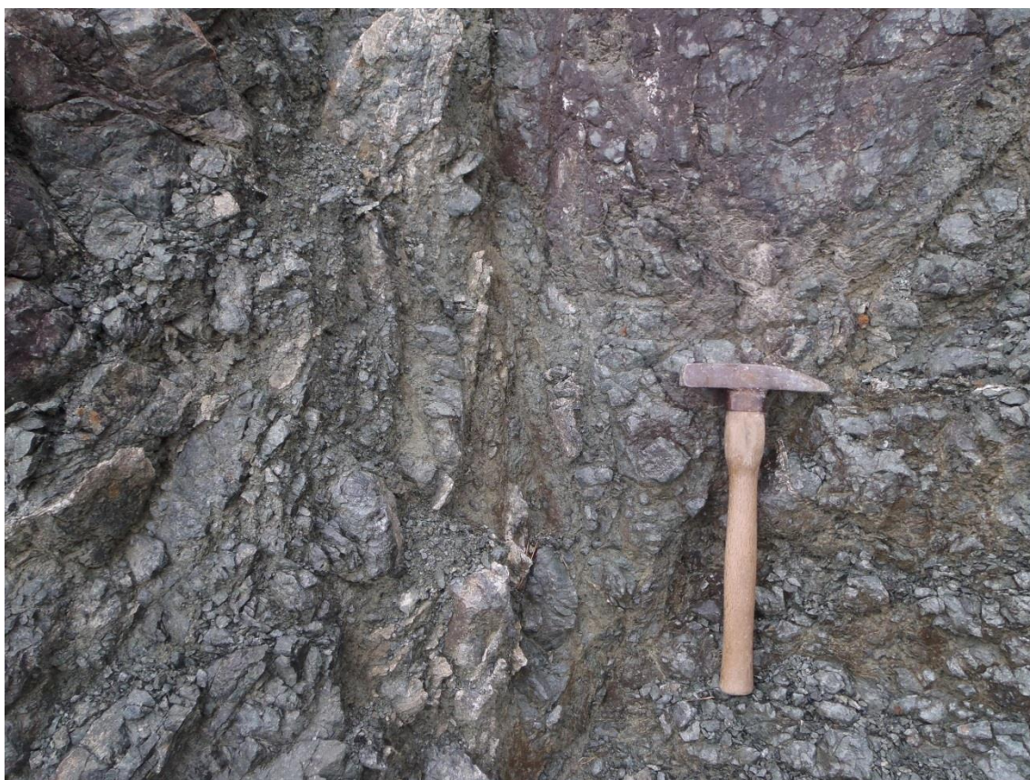
E76 N60E85N 方向の断層(破碎部)
