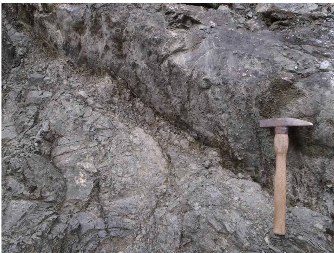
E80 N73E67S 方向の断層(破碎部)
