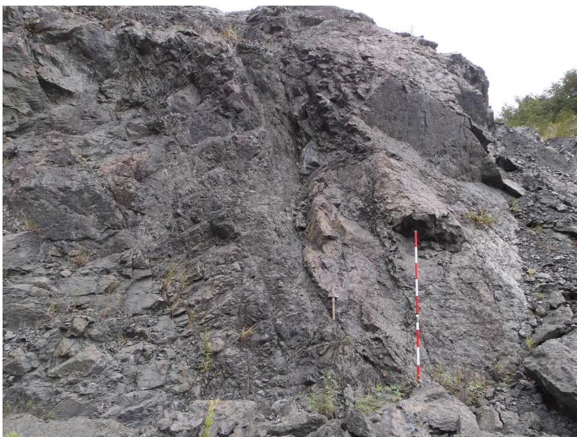
E64 N73W54S 方向の断層(全景)
