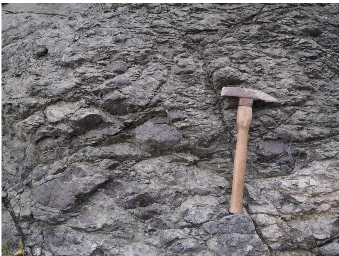
E28 CL～D 級の一部蛇紋岩化した部分の状況(拡大)
