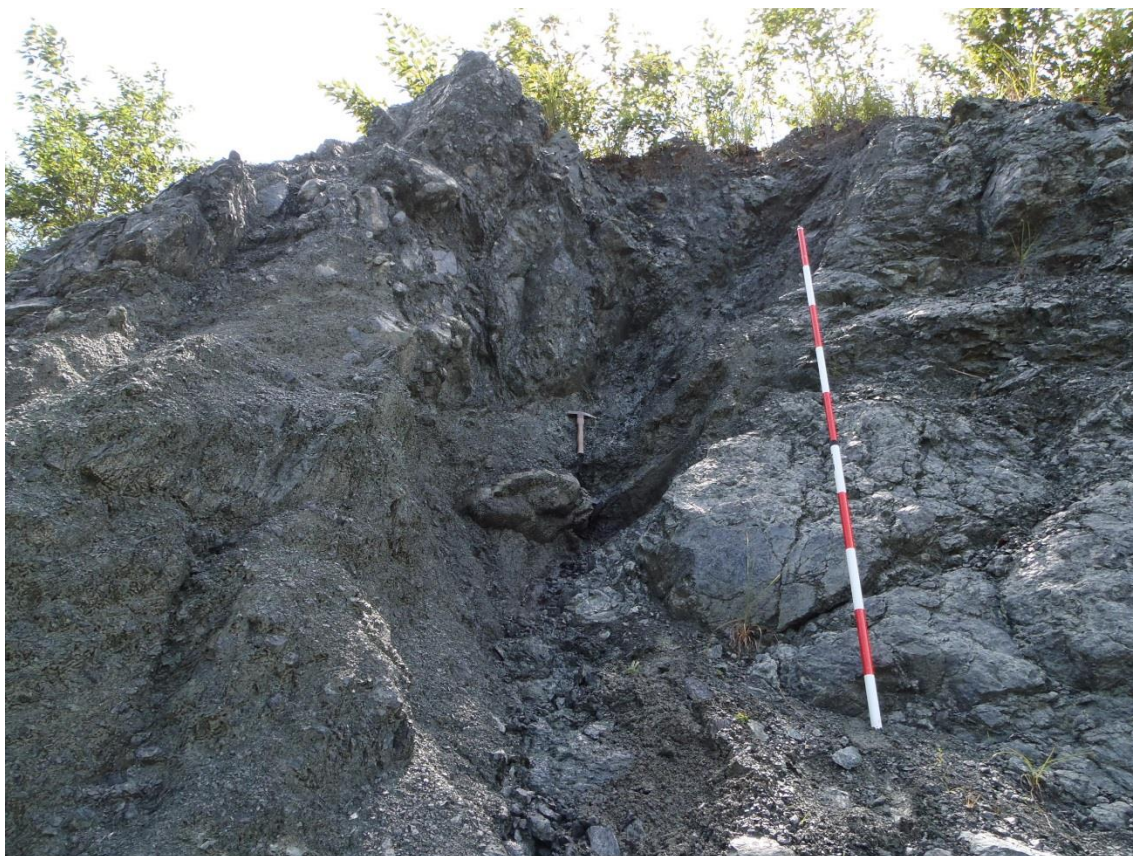
E43 N60W64N 方向の葉片状破碎を伴う割れ目(全景)
