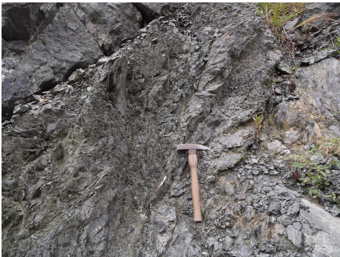
E67 N43W56W 方向の断層(破碎部)
