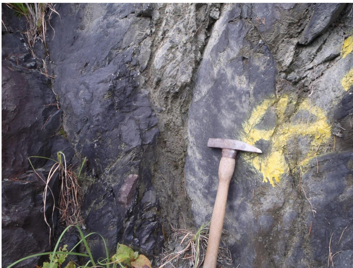
E72 N58E84N 方向の断層(破碎部)
