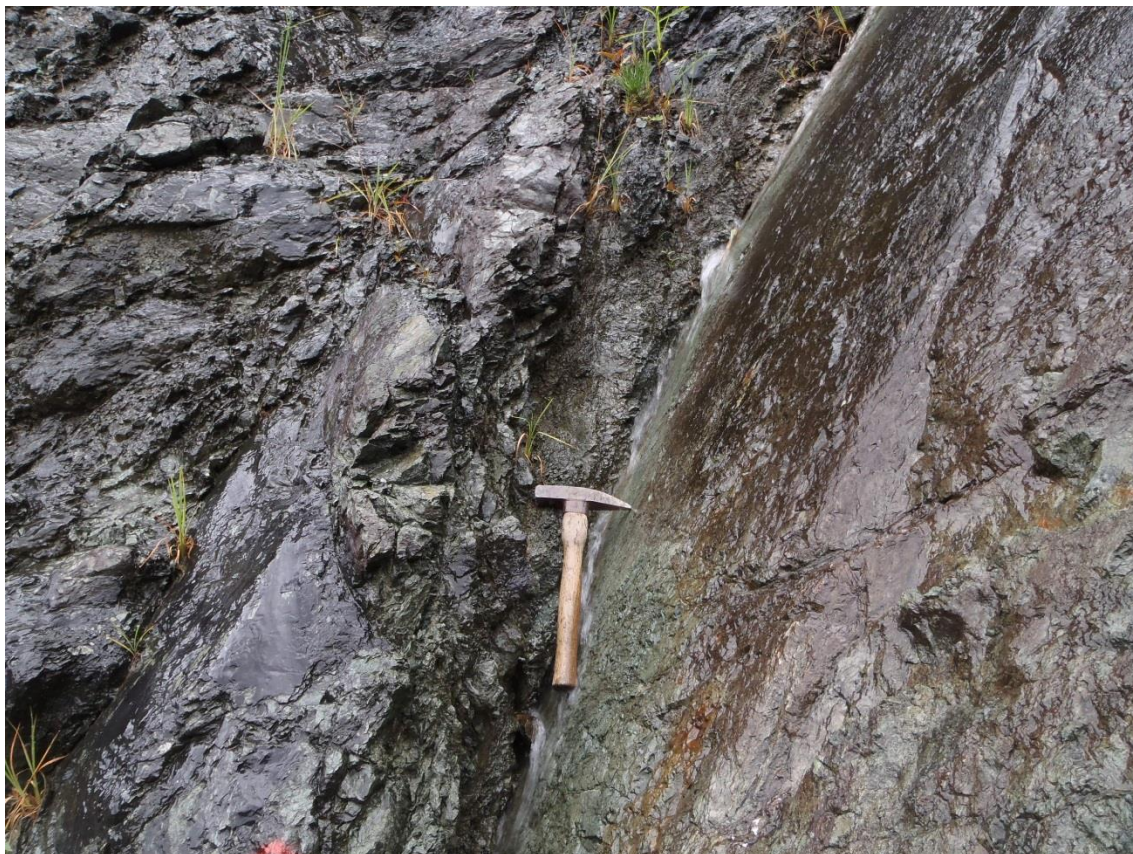
E3 N26E57N 方向の断層(破碎部拡大)
