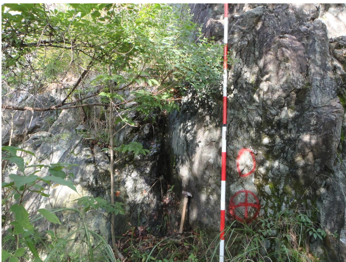
E68 N40E85N 方向の断層(全景)
