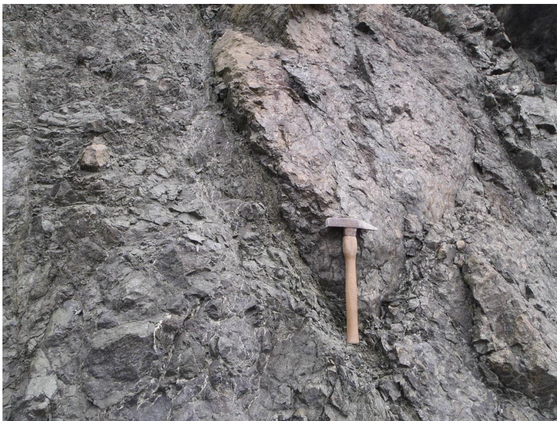
E65 N73W54S 方向の断層(破碎部)
