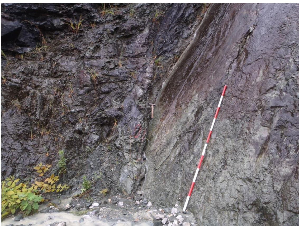
E2 N26E57N 方向の断層(破碎部)
