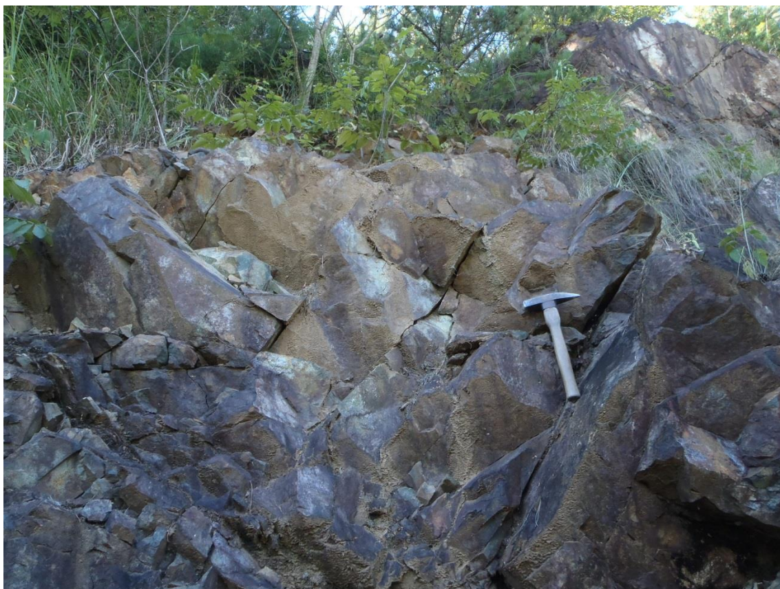
W1 N60E30S 方向の割れ目の卓越する CH 級の塊状緑色岩
