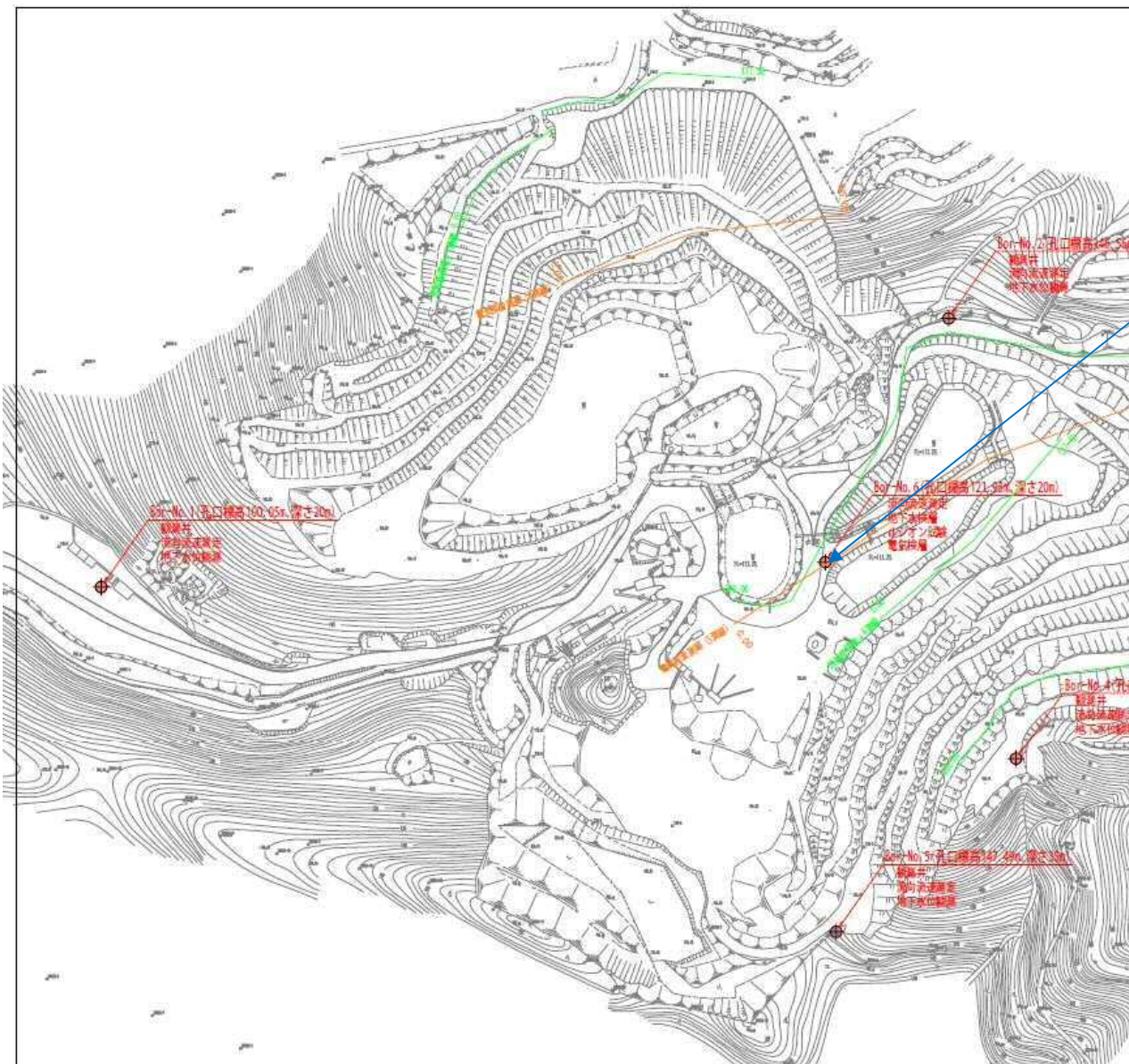
図 4-2-1-1 ルジオン試験位置とその結果 (「株式会社ミダック三嶽鉱山採石場跡地管理型最終処分場設置事業に係る生活環境影響調査 (地質水理構造、ボーリング調査), 平成 22 年 5 月」より)
